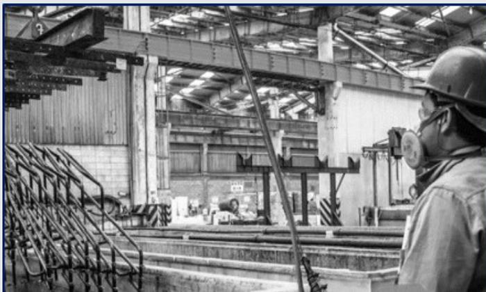
Figura 4. Inmersión de materiales en la tina de decapado. Tomado de archivos internos de Metalyzin S.A. de C.V.
