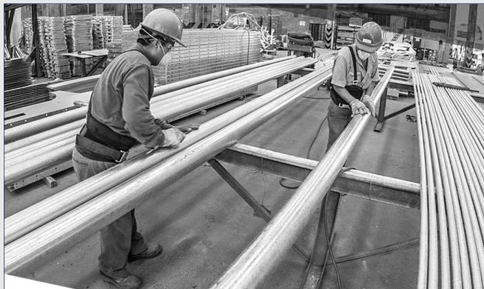
Figura 7. Eliminación de excesos de zinc para el acabado final del galvanizado. Tomado de archivos internos de Metalyzinc S.A. de C.V.
